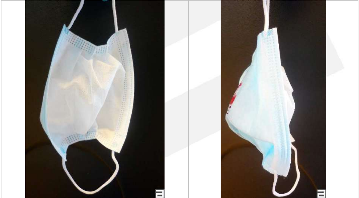
Cara interior: No se observa coloración de sangre sintética u otro tipo de penetración líquida Inner face: No synthetic blood or other liquid penetration is observed
