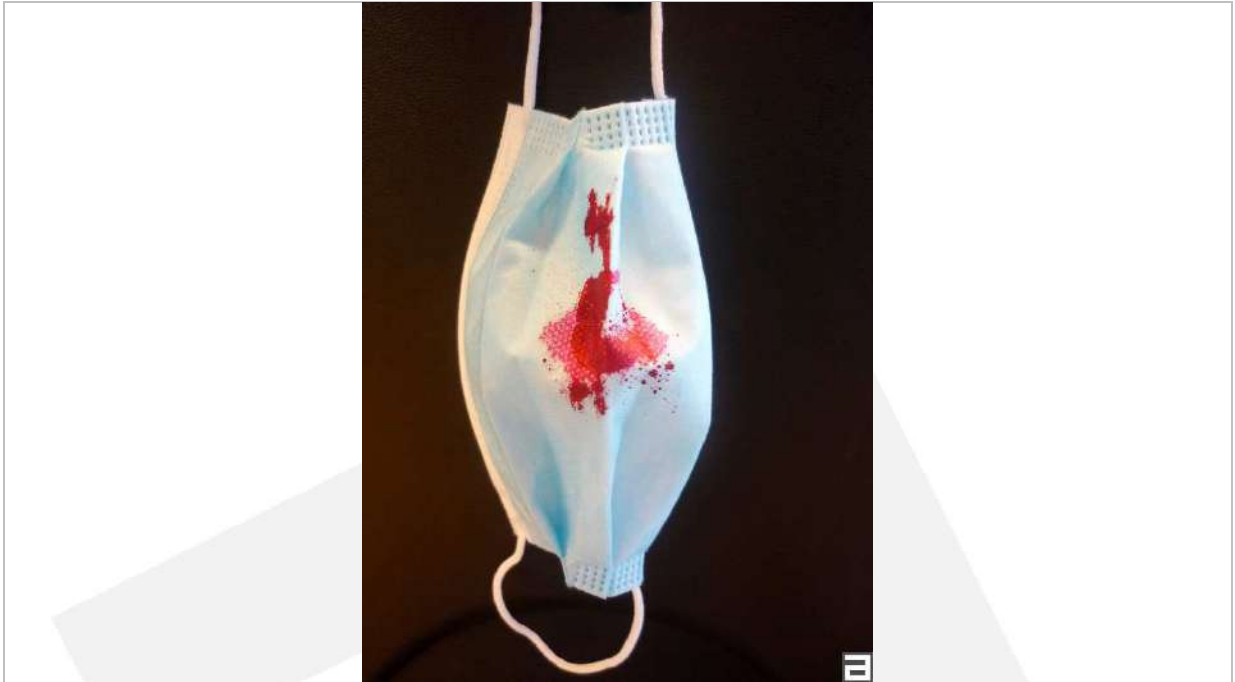
Cara exterior: Salpicadura de sangre sintética visible Outer face: Splatter of visible synthetic blood
